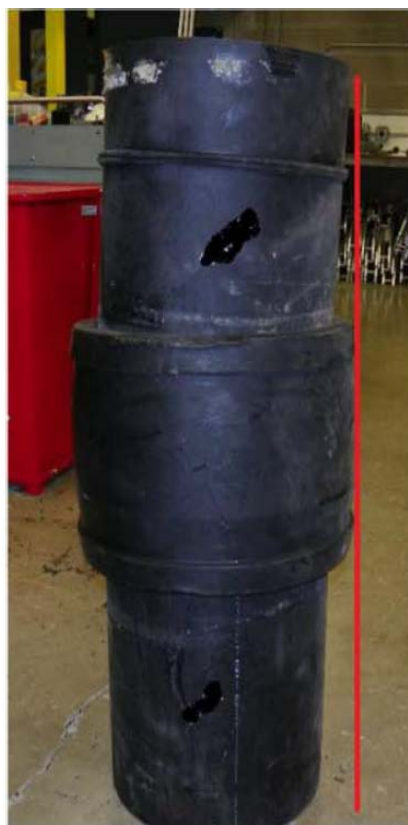
Фиг. 5. Тръбата и муфата не са правилно подравнени (несъосни)
