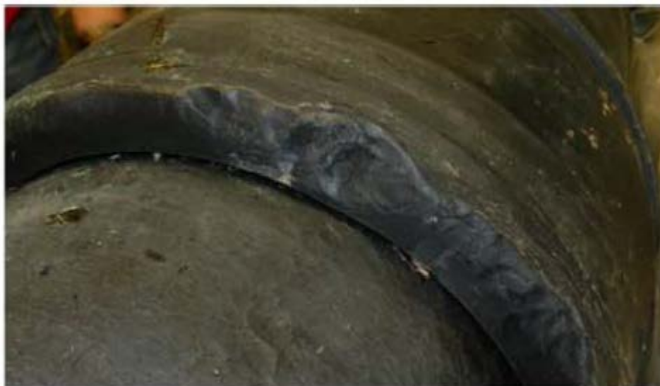
Фиг. 4 Ударите с чук по муфата показват, че краищата на тръбите не са подравнени и е била необходимо допълнително усилие за монтаж, предизвикало вътрешни напрежения.
