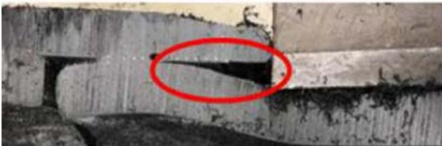
Фиг.9 Резултат от разрушителното изпитване – липса на сливане на 2-та материала (студена заварка)
