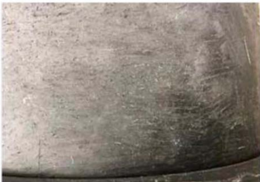
Фиг. 2 Повърхност на тръба, остъргана със скрепер
